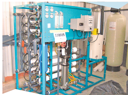
Alta tecnología. Equipo de membranas semipermeables fabricado por ESPINSA.
